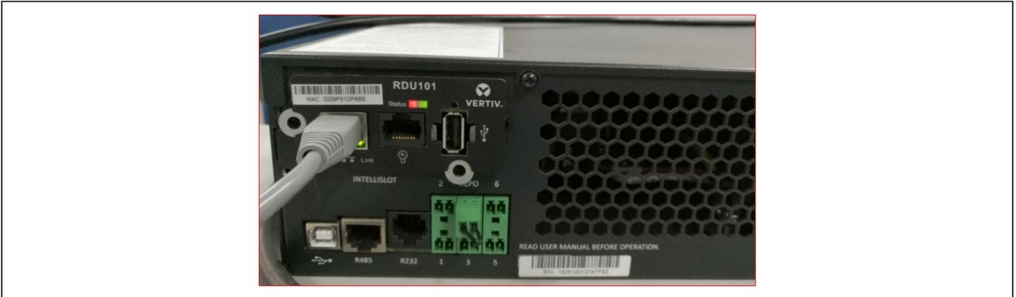
2. Branchez le connecteur RJ-45 à la voie R232 du système d'alimentation sans coupure. Pour connaître l'emplacement de la connexion, reportez-vous à la description du panneau arrière correspondant à votre modèle de système d'alimentation sans coupure à la section [Panneaux arrière](#), page 5.
