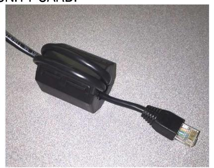
3. CLOSE FERRITE BEAD AROUND THE LOOPED CABLES.
