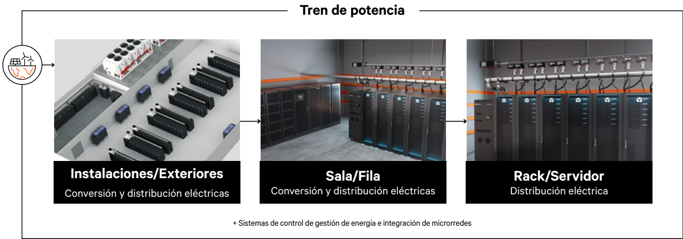
Figura 3. Al trabajar en conjunto, las tres etapas del tren de potencia del centro de datos respaldan una entrega eficiente de alimentación limpia y continua para los sistemas críticos, desde la red eléctrica hasta el chip.
