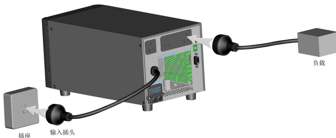
图2-1 输入电缆、负载连接图
