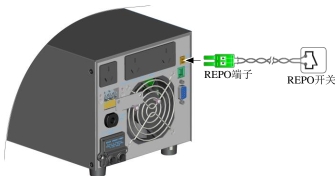
图4-1 REPO 端子接线示意图
