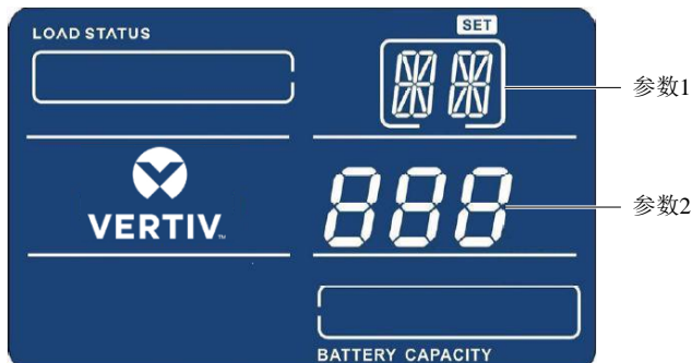
参数1：程序选项编号；本系统含有12个默认的设置程序，详细信息见表3-3。 参数2：用于在各程序中设定选项和值。
